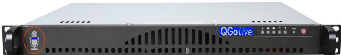
El nuevo servidor QGoLive dedicated 1 ru ejecuta el software QGoLive del receptor. Se puede conectar un monitor al servidor para monitoreo directo si se desea. La entrada y salida de audio se maneja mediante una interfaz USB que se proporciona. La interfaz disponible es XLR, ¼ de pulgada TRS o RCA. Para plantas totalmente digitales, simplemente proporcione su propio controlador LiveWire y listo, no se necesita una interfaz de audio externa.
